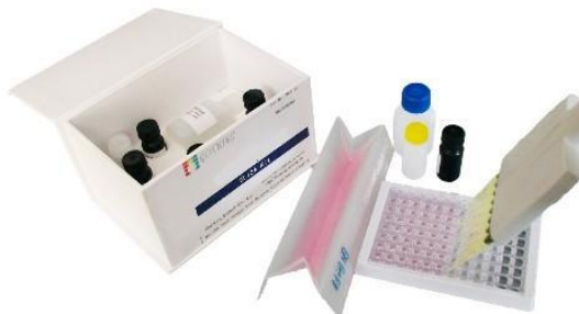
รูปที่ 3 แสดงชุดตรวจวัดสารในกลุ่มไนโตรฟูแรนโดยวิธี ELISA
