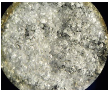
รูปที่ 9 ทรายขนาด -70+200 เมช ที่ผ่านการแต่งด้วยเครื่องแยกแม่เหล็กไฟฟ้า
