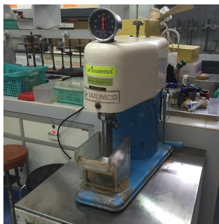
รูปที่ 4 เครื่องลอยแร่ขนาดห้องปฏิบัติการ
