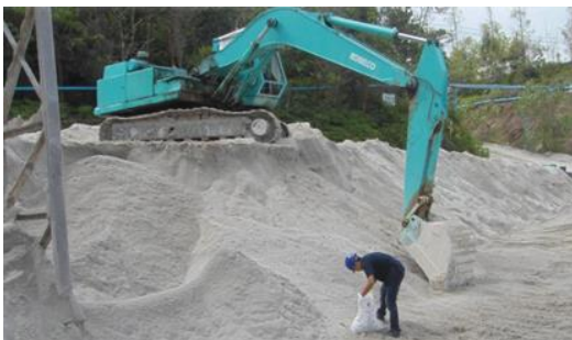
รูปที่ 2 การเก็บตัวอย่างทรายจากกระบวนการผลิต
