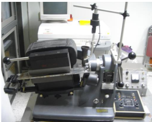
รูปที่ 5 เครื่องแยกแร่โดยอาศัยสมบัติการติดแม่เหล็ก Frantz Isodynamic Magnetic Separator
