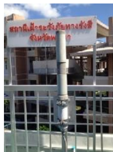
รูปที่ 1 แสดงหัววัดรังสีแกมมาชนิด proportional counter (Gas filled detector)
