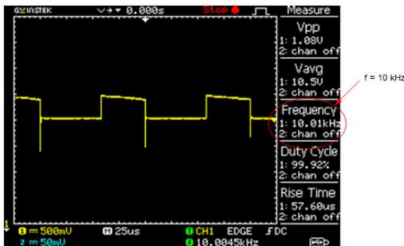
รูปที่ 4 Square wave form of PEF (10-30 kHz of input frequency)
