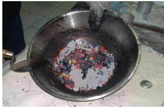
รูปที่ 2 การผสมขยะถุงพลาสติกกับแอสฟัลต์คอนกรีตในห้องปฏิบัติการ
