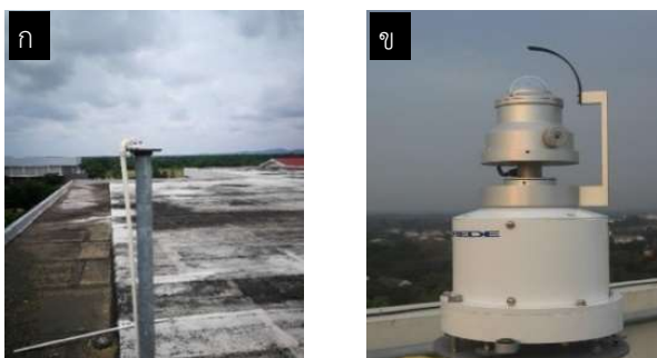
รูปที่ 2 (ก) Photon sensor สถานีวัดที่มหาวิทยาลัยบูรพา วิทยาเขตสระแก้ว (ข) เครื่องบันทึกข้อมูลภาพถ่ายท้องฟ้า Sky view สถานีวัดที่มหาวิทยาลัยศิลปากร จังหวัดนครปฐม
