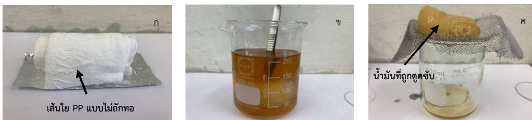
รูปที่ 2 ขั้นตอนการเตรียมการทดสอบค่าการดูดซับน้ำมัน ก) เตรียมเส้นใย PP ปริมาณ 4 กรัม ข) เส้นใย PP กำลังจุ่มอยู่ในน้ำมัน และ ค) แผ่นเส้นใย PP ที่ดูดซับน้ำมันเป็นเวลา 15 นาทีแล้วถูกนำขึ้นมาวางบนตะแกรงก่อนนำไปชั่งน้ำหนัก
