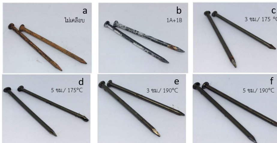
รูปที่ 11 ชิ้นงานผ่านการเคลือบโดยการอบอุณหภูมิและเวลาการอบต่างๆ แล้วแช่ชิ้นงานในน้ำเป็นเวลา 3 วัน a, b) ชิ้นงานที่ไม่มีการเคลือบผิวและเคลือบผิวด้วย 1A+1B c, d) เคลือบผิวด้วย 1ESO+1B อบที่อุณหภูมิ 175 องศาเซลเซียส เวลา 3 และ 5 ชั่วโมง e, f) เคลือบผิวด้วย 1ESO+1B อบที่อุณหภูมิ 190 องศาเซลเซียส เวลา 3 และ 5 ชั่วโมง
