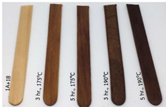
รูปที่ 9 ไม้เมื่อเคลือบผิวด้วย 1A+1B และ 1ESO+1B
